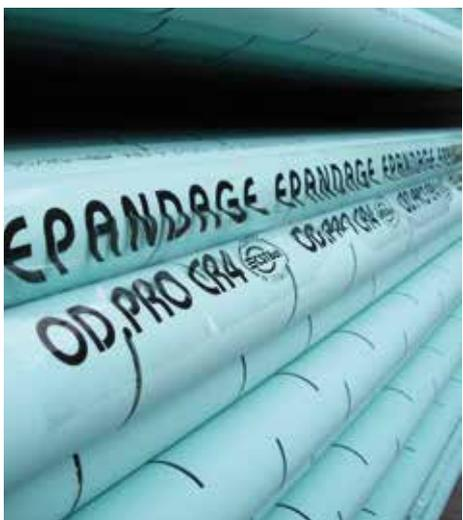
Tube PVC (Polychlorure de Vinyle) à parois structurées (3 couches), résistant aux agents chimiques des effluents transportés. Sa paroi lisse comporte des fentes transversales alternées.
